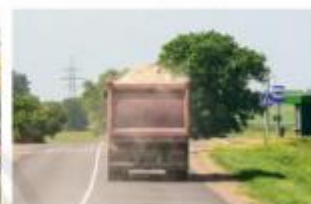
▲ Hình 10.11. Vận chuyển vật liệu xây dựng không che bạt
