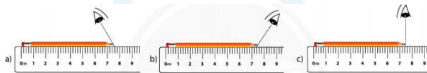
▲ Hình 4.5. Cách đặt mắt khi đo chiều dài
